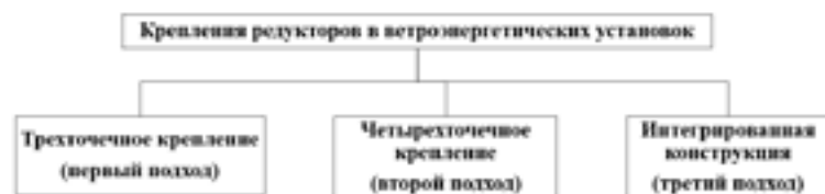
Рисунок 1 – Классификация ВЭУ по монтажу трансмиссии
