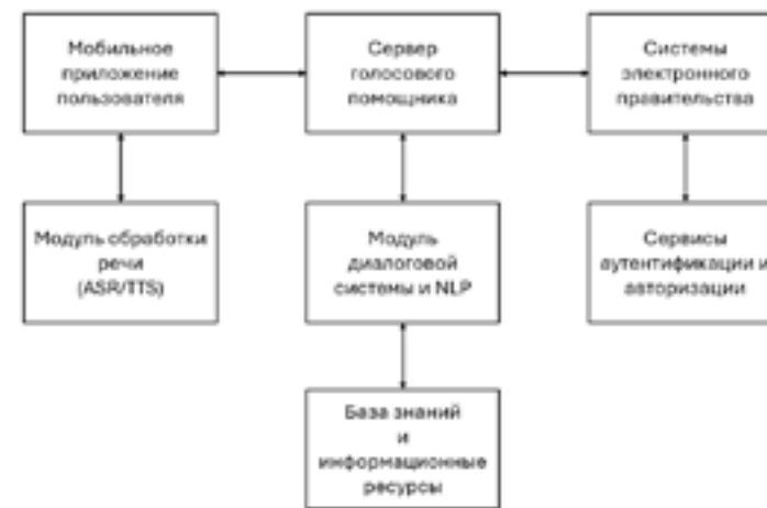
Рисунок 1 – Предлагаемая архитектура голосового помощника для мобильного приложения электронного правительства
